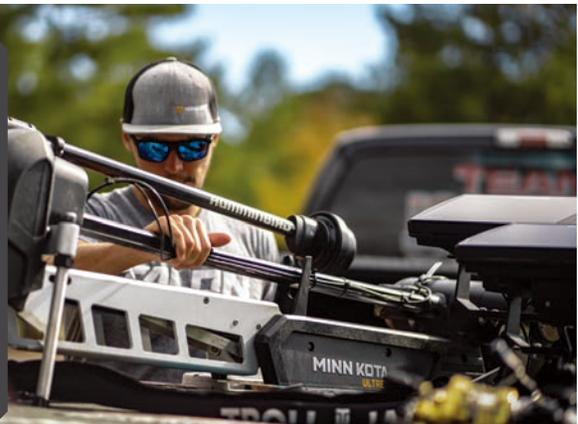
ユニバーサルソナーを搭載した i-Pilot スタンダード ULTREX モデル。ケーブルフットコントロールのフィーリングを完全移植した電子ステアリング採用。2021年レンタルポート用として新たに 34 インチモデルを投入。1 台のエレキに 4 台のリモコンをペアリング可能。
