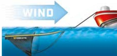
強風の中でボートポジションをコントロールする際に絶大な威力を発揮します。ウェイトとフロートを内蔵しているので、水中に投入することで自動的にパラシュートが開きます。
