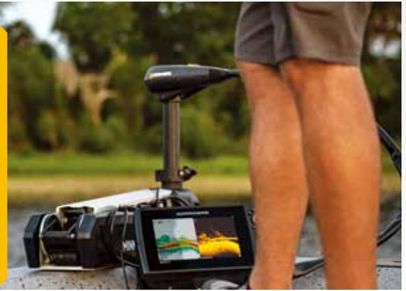
バスボートの最強パートナーとなったフォルトレックス。一体型モノ・アームマウントにより強度が向上。ガス圧式ダンパー搭載で、揚げ降ろし時の負担を軽減。
